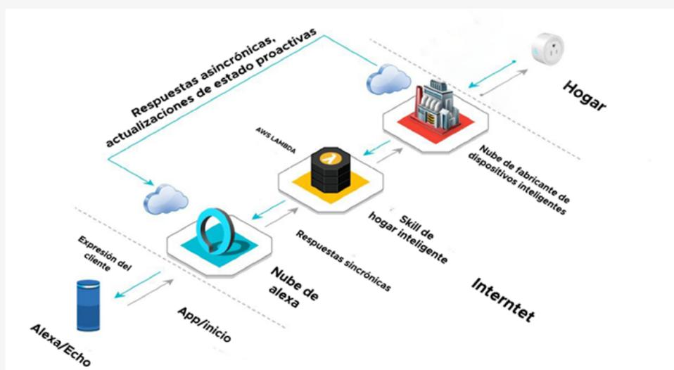
El proceso de interacción entre el usuario, Amazon Alexa y el tomacorriente inteligente compatible se inicia cuando el usuario emite un comando de voz a través de un dispositivo compatible, como un altavoz inteligente o un teléfono móvil.
