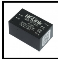
Figura SEQ Figura \* ARABIC 3 Hi-link Fuente de Poder 3.3v
